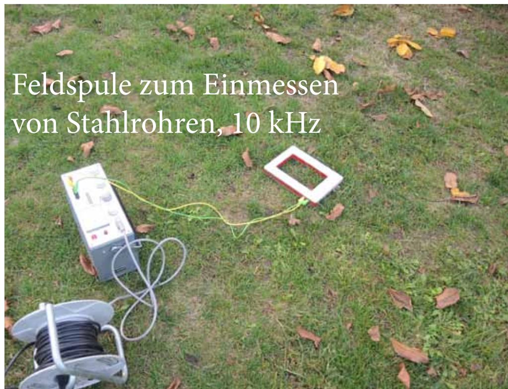
Feldspule zum Einmessen von Stahlrohren, 10 kHz
