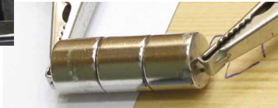
Gleichstrom von einigen nA fließt durch einen Magneten
