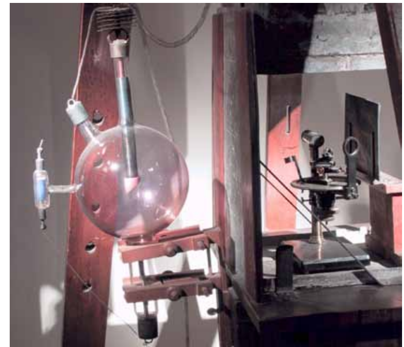
Versuchsanordnung zur Röntgenbeugung von W. Friedrich, P. Knipping und Max von Laue, 1912, Deutsches Museum
