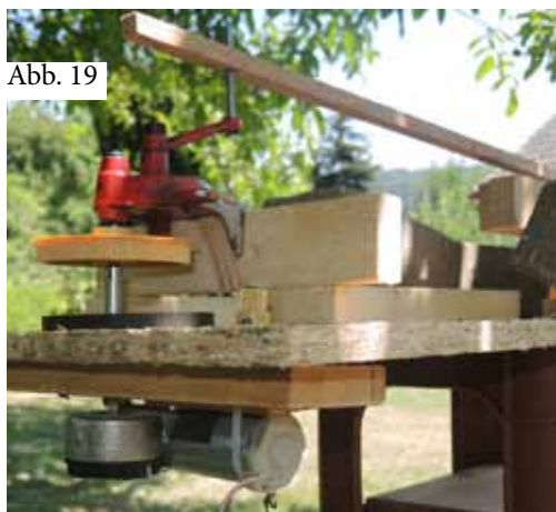
Abb. 19: Elektromotor mit Getriebe, Kurbel und Holzstange
