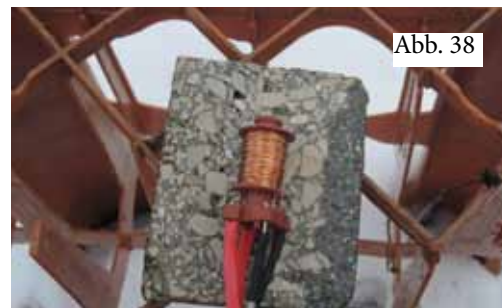
Abb. 38: Eine Kupferspule mit Ferritkern liegt auf einem Betonstein, dem Endpunkt eines SixPacks.
