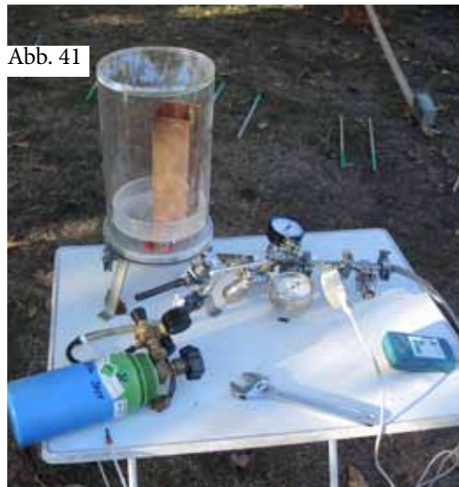
Abb. 41: Vakuumkammer mit Füllrichtung für die Edelgase Helium, Neon, Argon, Krypton und Xenon. In der Kammer befindet sich gerade das Ziel für einen PsiTrack, das Kupferblech von Abb. 14.
