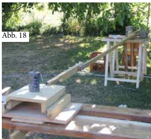
Abb. 18: Er liegt auf einer Schublade aus Holz, die sich über eine lange Holzstange von einer Kurbel antreiben lässt.
