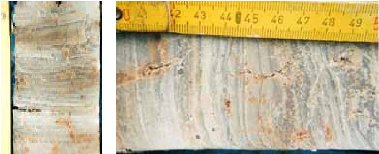
Abb. 2.2.4-9: Querschnitt durch einen Bohrkern mit Wechsellagerungen
