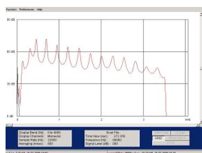
Die nur wenig aufwendigere Bestimmung der akustischen Impedanz zeigt die Aufeinanderfolge der Obertöne in einem bunten Kunststoffrohr. Hierzu wurden bei akustisch sehr loser Ankopplung die Maximalwerte des Mikrophonsignals aufgezeichnet, während die Frequenz in einer Rampe hochgefahren wurde. (R. Horne, Spectrogram)
