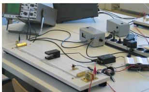
Schwingende Saite mit Wechselstrom erregt, in der Mitte der verschiebbare U-förmige Permanentmagnet zur Erzeugung der Lorentzkraft. Zum Antrieb dient ein NF-Generator, ein Audio-Verstärker für Kraftfahrzeuge und eine Auto-Glühhirne als Vorwiderstand und zur Stromanzeige. Das kleine Mikrophon am rechten Ende der Saite hört die Schwingungen einer kleinen Klebefolie auf der Saite.
