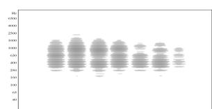
Zur Frequenzbestimmung dient das Programm Spectrogram von R. Horne, wie hier bei der Posaune, die durch Klatschen mit der flachen Hand auf das Mundstück angeregt wurde. Die Frequenzen lassen sich mit dem Cursor auf dem Bildschirm ablesen. Der tiefste (erlaubte) Ton hat nach der Steigung der Geraden die Frequenz von 60 Hz. Profis schaffen aber auch noch einen physikalisch verbotenen mit etwa 32 Hz.
