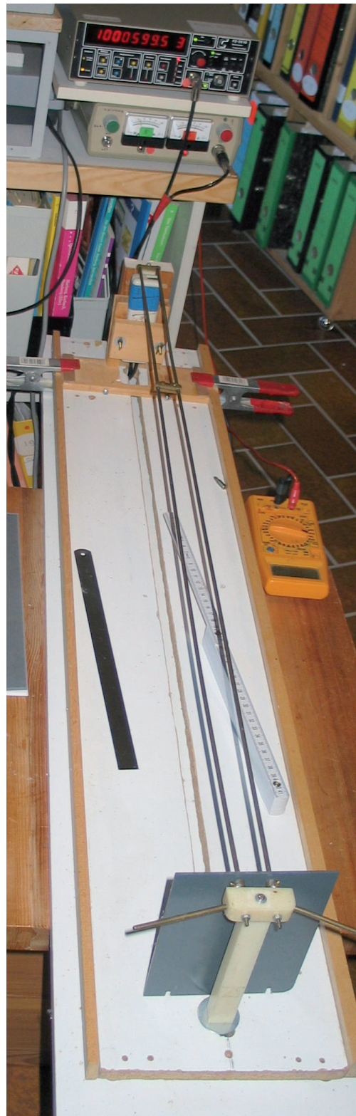
Abb. 17: Lecherantenne nach Reinhard Schneider. Es ist eine kupferkaschierte Leiterplatte mit angenieteten Messingrohren. Der durchsichtige Schieber oben enthält einen versilberten Draht, mit dem die beiden Leiter kurzgeschlossen werden.
