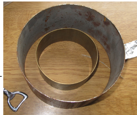
Abb. 07: Zwei Hohlkörper aus unterschiedlichen Materialien: Messing und Eisen. Rechts verbindet ein kleiner Draht beide Körper elektrisch miteinander.
