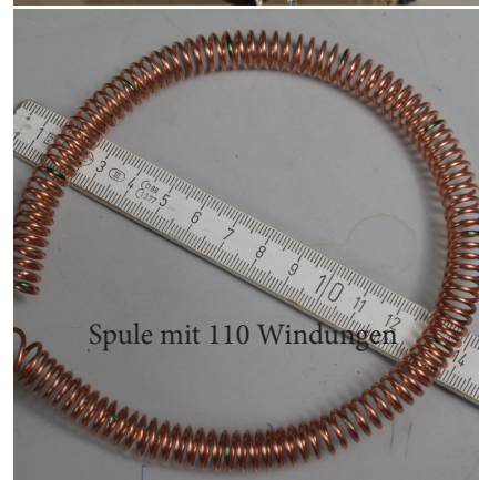
Abb. 20a; 20b; 20c: die drei Spulen mit 28; 60 und 110 Windungen
