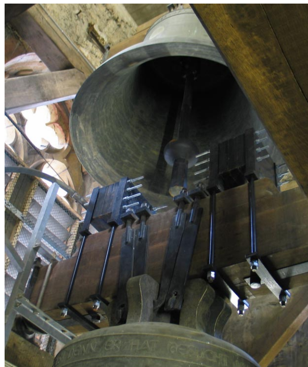
Abb. 11: Die Glocke „ais“ mit Zusatzmassen auf dem Joch zur Verringerung der Läutefrequenz.
